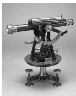
Fig. 4 y 5, Brújula taquimétrica y teodolito de tercer orden del mismo tipo que los utilizados en la medición.
